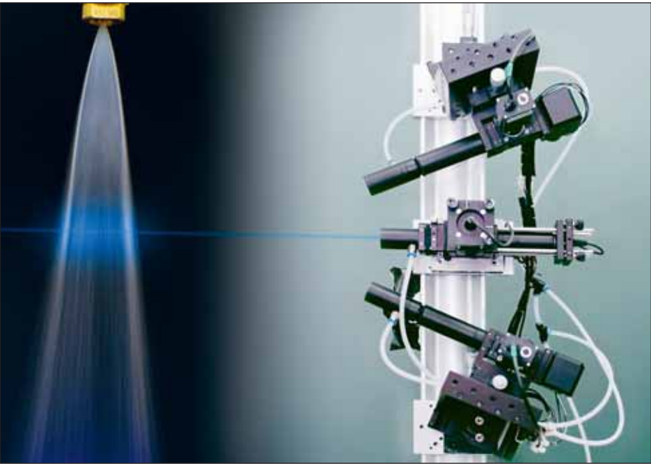
Mess-Experiment zur Charakterisierung von Tropfen und Partikeln in einer Strömung: Die Erkenntnisse sind wichtig für die Verfahrenstechnik, etwa bei Sprühtrocknungs- oder Lackierv Verfahrenen.
