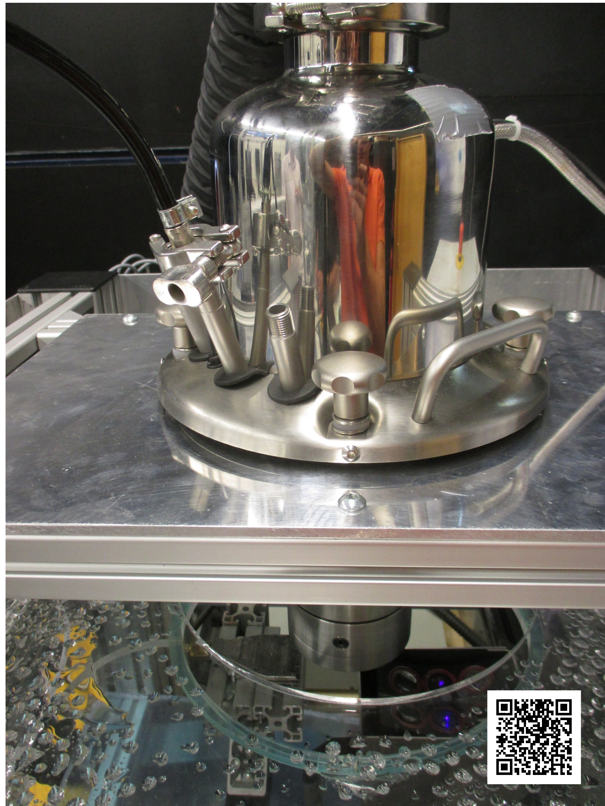
Abbildung 1: Abbildung 1: Experimenteller Aufbau in Draufsicht mit einem Rotationszerstäuber der Firma GEA Niro. Der radiale Spraystrahl wird in einer Plexiglaswanne aufgefangen. Unterhalb des Zerstäubers ist die Messsonde [1] positioniert.
